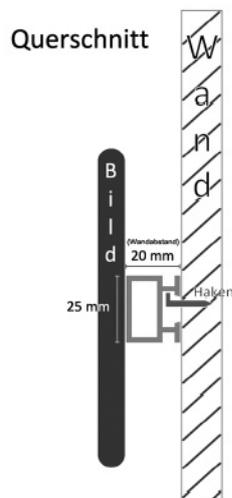
Die fertige Platte kann nun mit Hilfe von Wandhaken, Schrauben o.ä. an die Wand gehängt werden.
